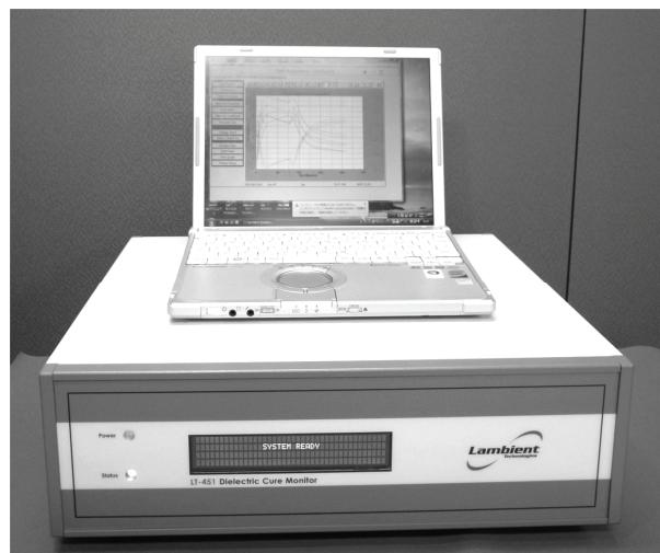
図 1 ポリマー硬化自動測定装置
