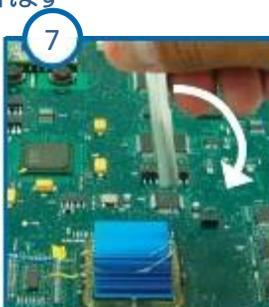
7 フレームクリップのリップ部の下に、スプリングクリップの開いた方をあてがいます
