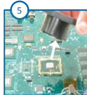
5 ノブツールを離すと、フレームクリップがコンポーネントに取り付けられます
