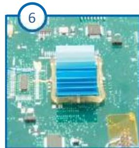
6 コンポーネントの上からヒートシンクを取り付けます。取付け向きにご注意ください
