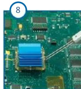
8 スプリングクリップツールのフォーク状の部分を使い、スプリングクリップの閉じた方をフレームクリップの突起に引っ掛けます
