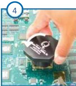
4 フレームクリップの付いたノブツールをコンポーネント上に置いて、反時計回りに45度回すとフレームクリップが外れます
