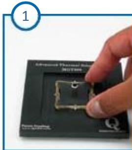
1 フレームクリップを、ベースプレートに取り付けます
