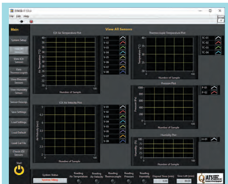
iSTAGE-X アプリソフトによるデータ測定画面例 (風速8ch・差圧2ch・熱電対4ch・湿度1ch)
