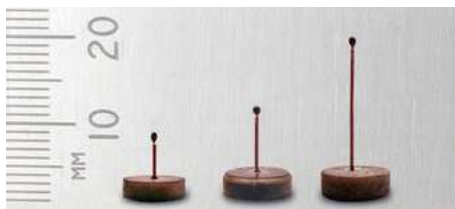
キャンドルスティック型小型センサ 風速0.1 ~ 50m/sec、-20°C ~ 120°C 高さ9/12/20mm、ベースφ9.5mm センサケーブルも10mまで対応
