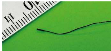
極細表面温度センサ 温度範囲-10°C ~ 150°C
