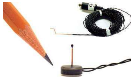
狭小スペースでの風速・温度測定にカスタム形状のセンサにも対応しています。
